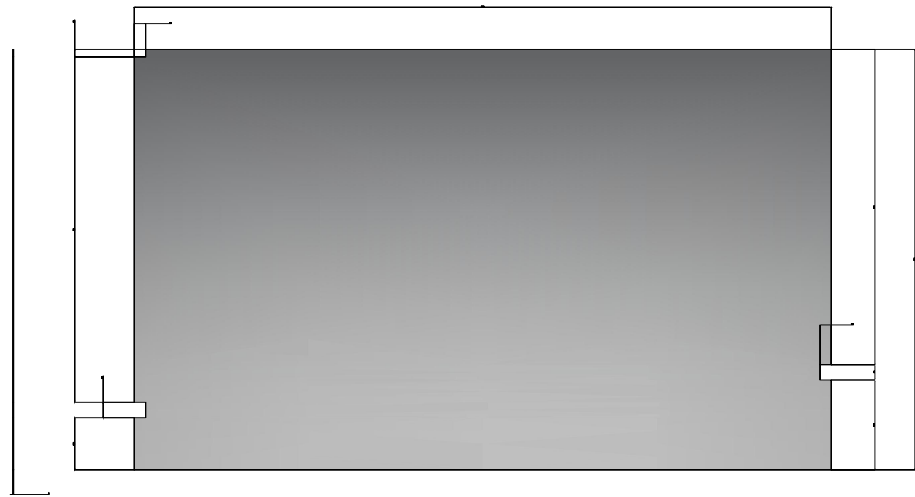
Descrição: CH PISO - #3MM ASTM A36 Desenho N° 2.02.321P
